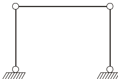
Figura 3.8 Pórtico com ligações articuladas.
