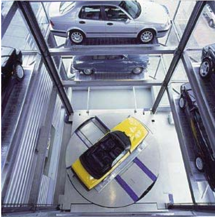
Figura 5.10 - SAAB-Centre Krefeld Wöhr Car Display Tower - Berlim - Alemanha Fonte: Wöhr Parksysteme - Disponível: < http://www.woehr.de/engl/download/pdf_files/distower/displaytower.pdf > Acesso: 19 abr. 2004
