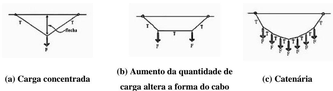
Figura 3.11 – Configuração de um cabo, sob carregamento
