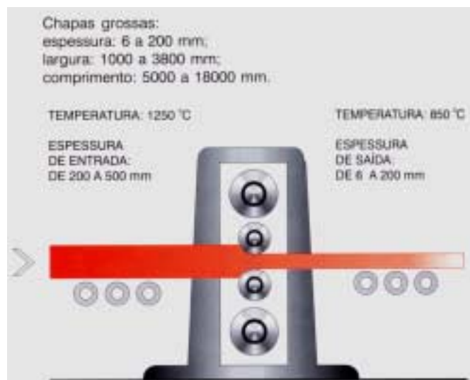
Figura 2.20: Laminador de tiras grossas a quente (Dias, 2002)
