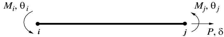
Figura 5.2 - Elemento de viga-coluna referenciado ao sistema corrotacional
