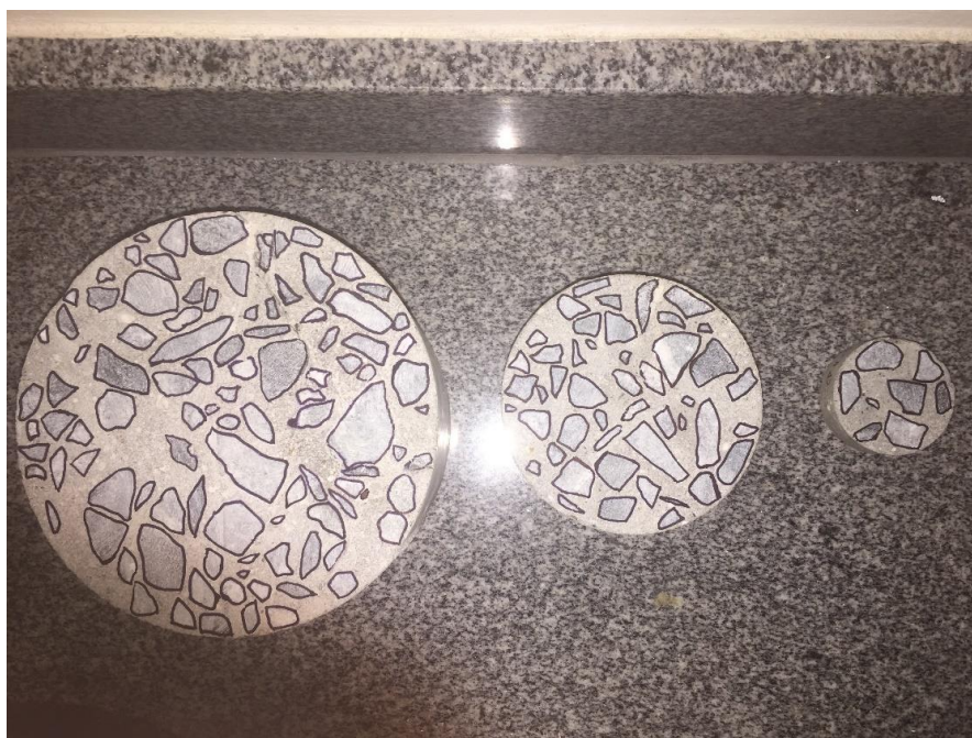
Figura 5 - Contorno dos agregados graúdos em pincel para diferentes tamanhos de seções transversais.
