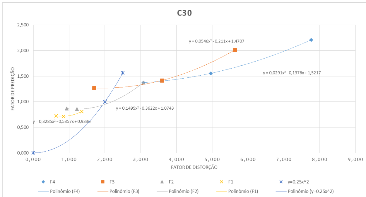
Figura 24 - Curvas de calibragem obtidas por plotagem dos fatores de distorção e predição, para diferentes faixas granulométricas e classe C30, adotando E_d
