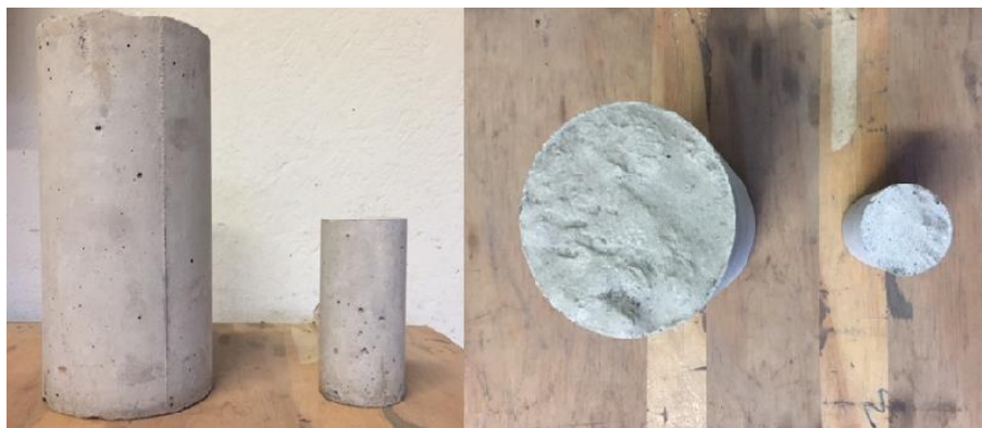
Figura 4 - Corpos de prova de \varnothing 100 \times 200 mm e \varnothing 50 \times 100 mm, por vistas lateral e superior, respectivamente.
