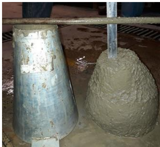
Figura 21 - Teste slump do concreto de REF-P14-310
