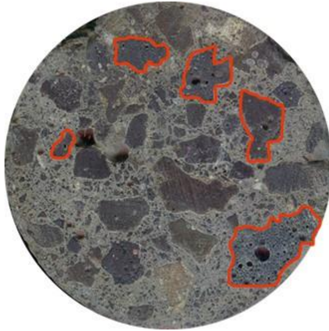
Figura 28 - Seção de um corpo de prova de concreto produzido com agregado de escória de aciaria
