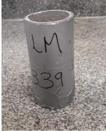
Figura 10 - Corpo de prova preparado para ensaio de penetração de cloretos
