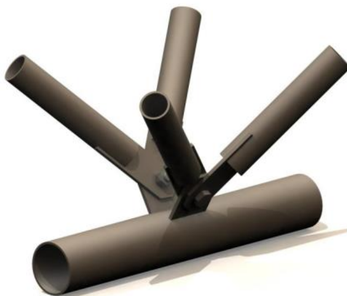
Figura 1.21 - Ligação entre banzo e diagonais com chapa gusset em uma treliça multiplanar Fonte: Silva (2014)
