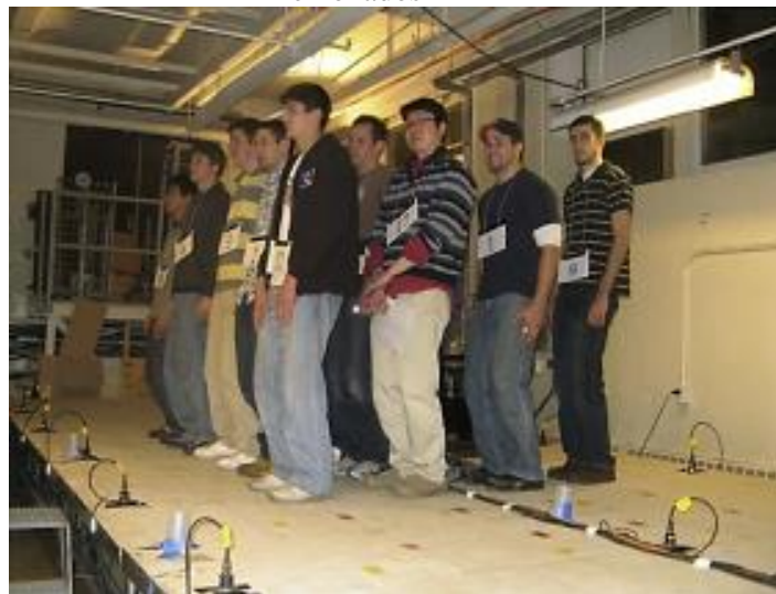
Figura 2. 17. Teste experimental com relação de massa de 0,431 para 19 pessoas com joelhos semi-flexionados
