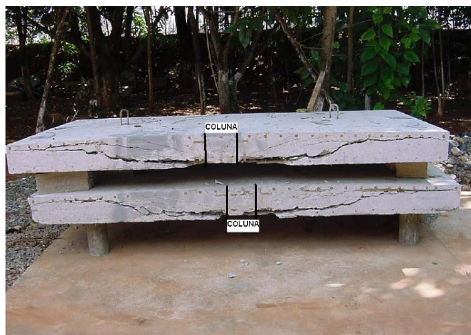
Figura 1.4: Lajes cortadas ao meio após a ruptura nos ensaios (TRAUTWEIN, 2006).
