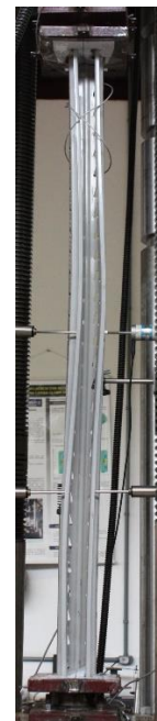
Figura 3.15: Deslocamento dos flanges de ligação (Coluna de 1400 mm de comprimento)
