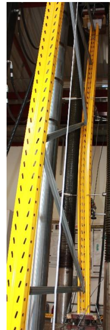
Figura 3.32: Deslocamento dos flanges de ligação (Painel de 2400 mm de comprimento – Lado B)
