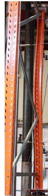
Figura 3.22: Deslocamento dos flanges de ligação (Painel de 2000 mm de comprimento – Lado A)
