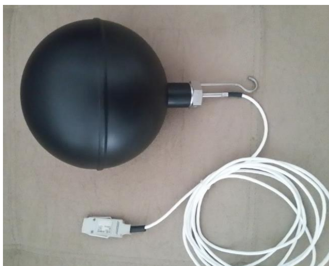
Figura 31 - Termômetro de globo negro - Modelo ALMEMO Class B (DIN/IEC 751)
