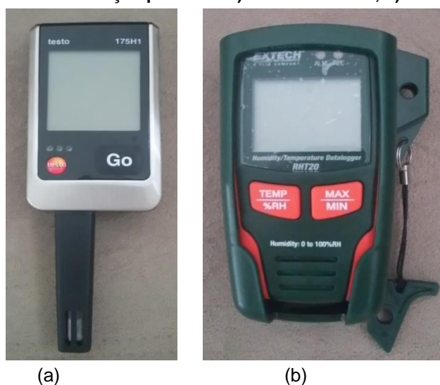
Figura 26 – Equipamentos de medição portáteis: a) TESTO 175H1 E; b) Extech Instruments RHT20
