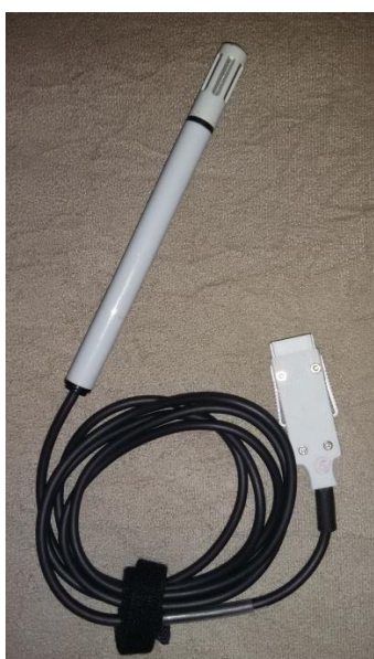
Figura 30 - Sensor de temperatura e umidade - Modelo ALMEMO 3290
