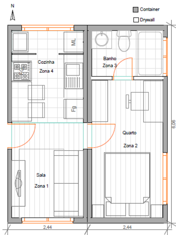
Figura 3.3: Planta da casa em contêiner
