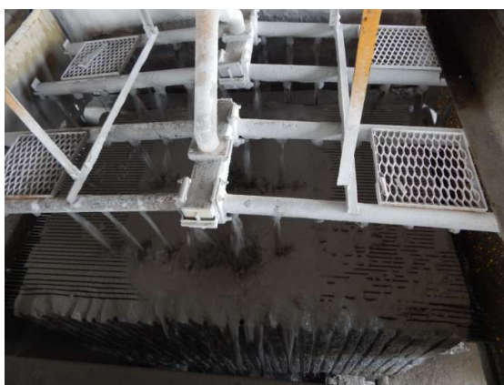
FIGURA 2.4 – Detalhe da aspersão da polpa abrasiva sobre durante o corte no tear tradicional.
