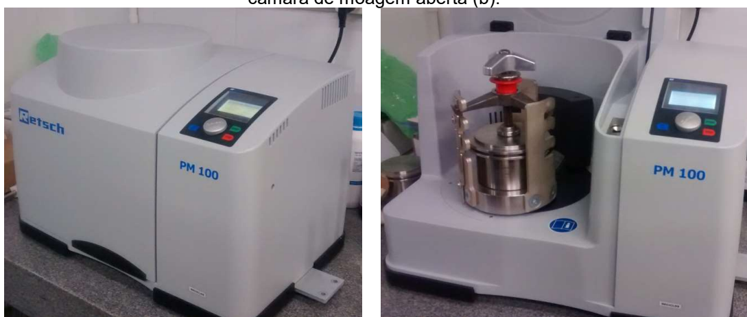
FIGURA 3.3 – Retch Planetary Ball Mill PM 100 do LMC 2 /UFOP: Moinho fechado (a) e moinho com câmara de moagem aberta (b).
