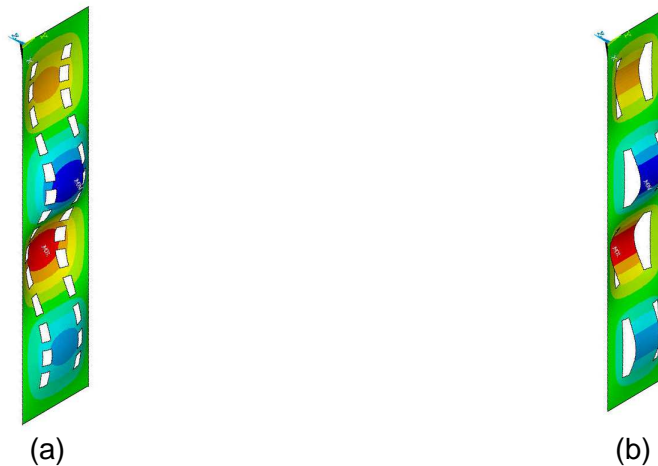
Figura 1.7. Modos de flambagem observados na placa: (a) Modo Local; (b) Modo Localizado de Placa.
