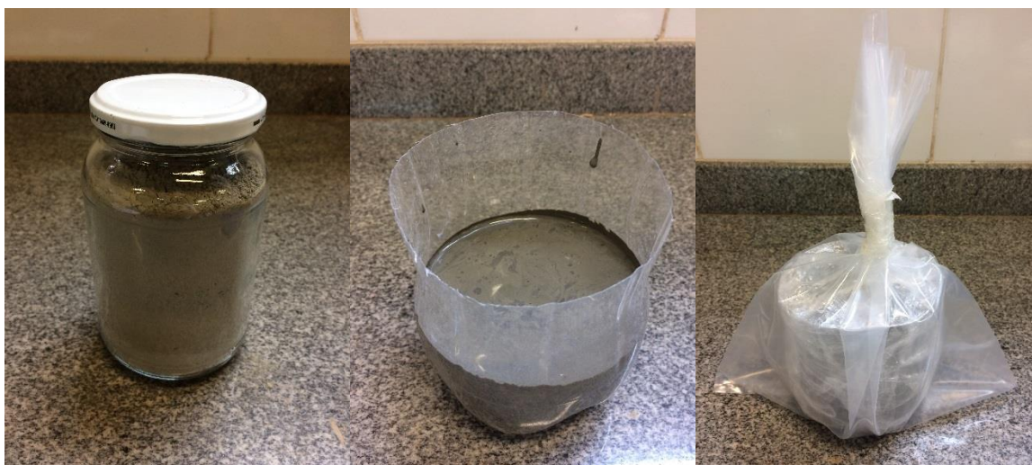
Figura 4.7 – Procedimento de Execução das Pastas de Cimento Portland (Fonte: Autor)
