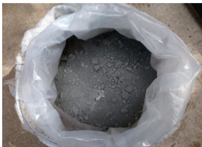
Figura 3.2 – Resíduo de Corte de Ardósia (RCA) in natura (Fonte: Autor)
