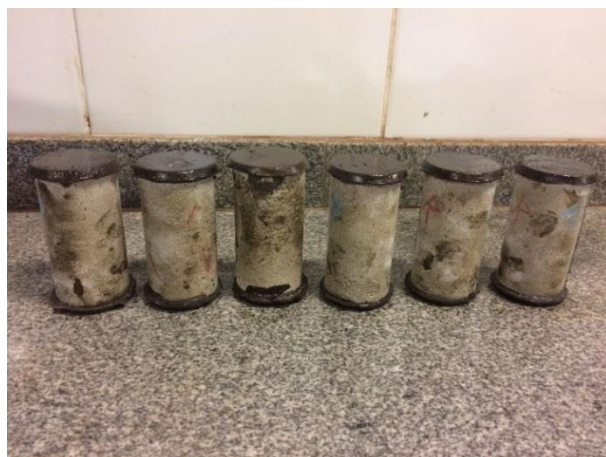
Figura 4.10 – Corpos de Prova Capeados com Mistura de Enxofre a Quente (Fonte: Autor)
