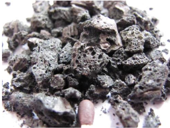
Figura 2.5 – Aspecto da Ardósia Cinza de Minas Gerais Moída e Expandida na Empresa Stalite Co. (Fonte: Chiodi Filho e Chiodi, 2014)
