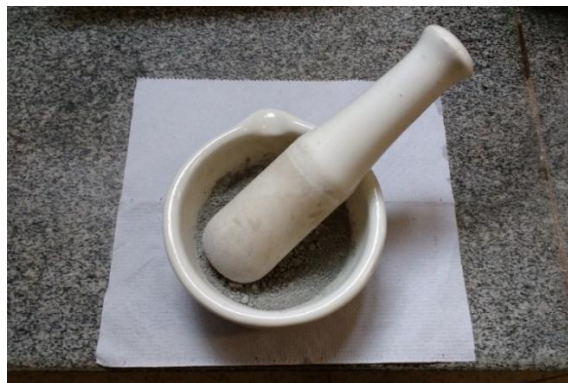
Figura 4.5 – Desaglomeração do RCA em Almofariz de Porcelana (Fonte: Autor)
