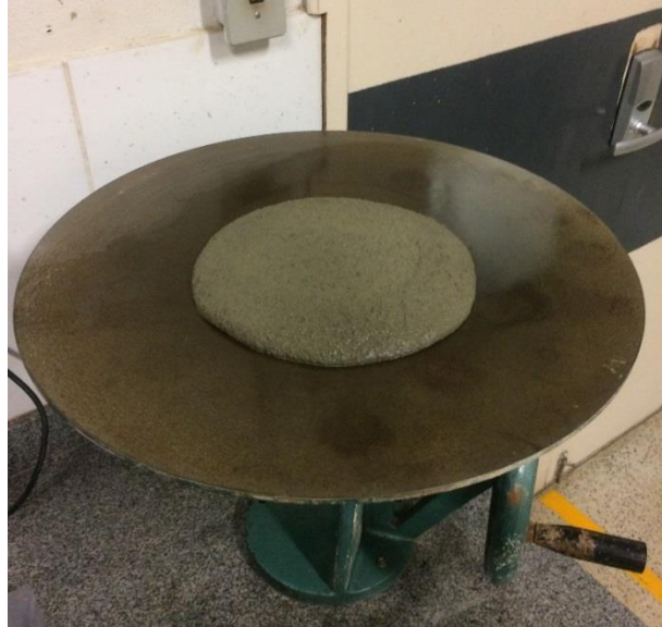
Figura 4.9 – Ensaio de Determinação do Índice de Consistência na Mesa (Fonte: Autor)
