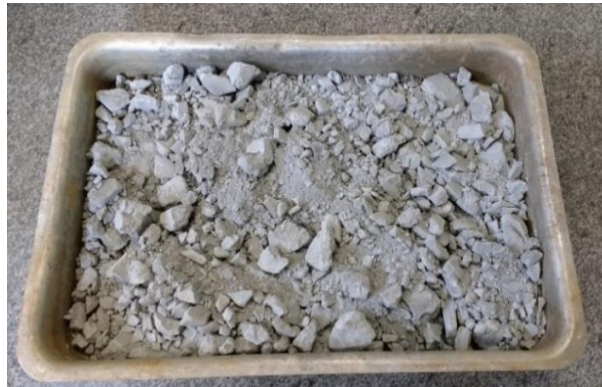
Figura 4.4 – Resíduo de Corte de Ardósia (RCA) Seco em Estufa (Fonte: Autor)
