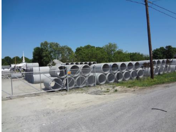
Figura 2.4 – Artefatos de Concreto Fabricados com Agregados Leves Obtidos a partir de Ardósia Termicamente Expandida no Pátio da Stalite Co. (Fonte: Chiodi Filho e Chiodi, 2014)
