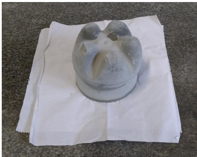
Figura 4.8 – Pasta de Cimento Portland após Período de Cura (Fonte: Autor)
