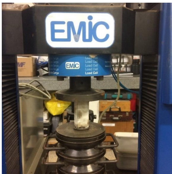
Figura 4.11 – Corpo de Prova em Ensaio de Compressão na Prensa Hidráulica (Fonte: Autor)
