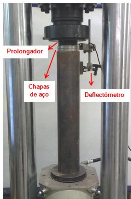
Figura 3.10 - Montagem e instrumentação para o teste de cisalhamento.
