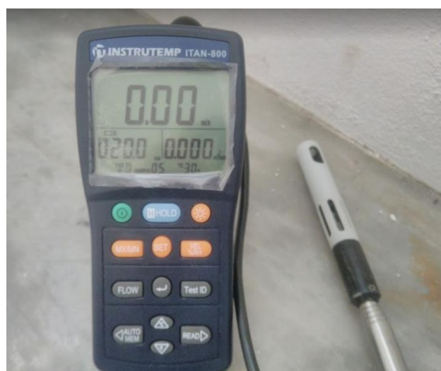
Figura 3.9 – Anemômetro de fio quente Instrutemp ITAN-800
