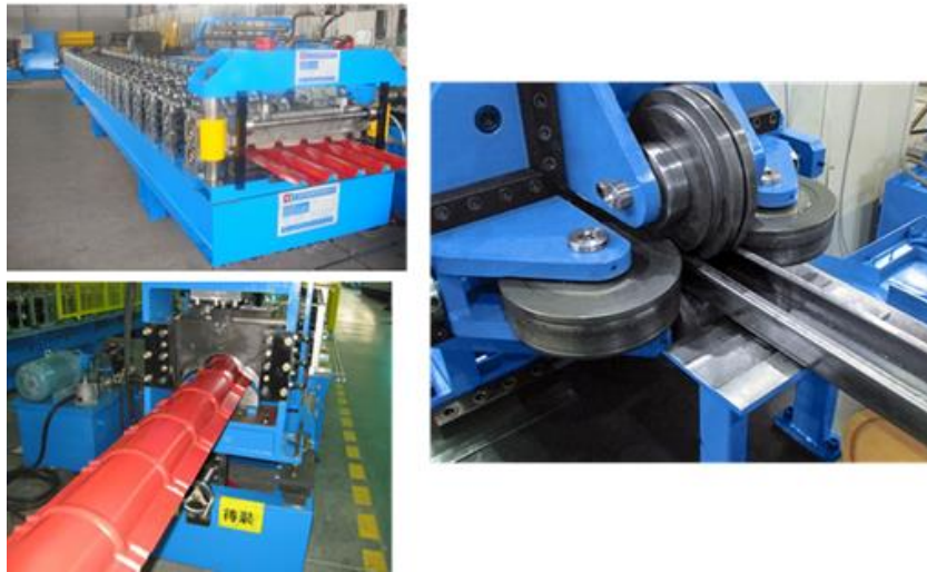
Figura 1. 8 – Processo de conformação a frio – perfilagem.
