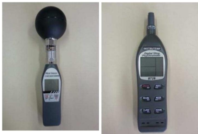
a – Termômetro de Globo b - Psicrômetro Figura 3.9 – Aparelhos utilizados para as unidades móveis. Fonte: Nascimento (2016)
