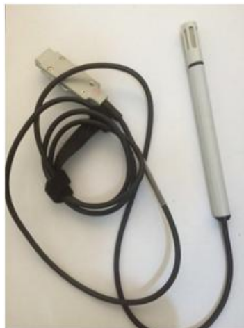
Figura 3.12 - Sensor de temperatura e umidade - Modelo ALMEMO 3290. Fonte: AHLBORN (2011)
