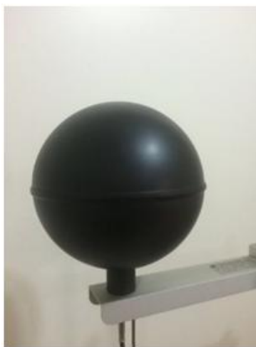
Figura 3.13 - Termômetro de globo - Modelo ALMEMO Class B (DIN/IEC 751). Fonte: AHLBORN (2011)
