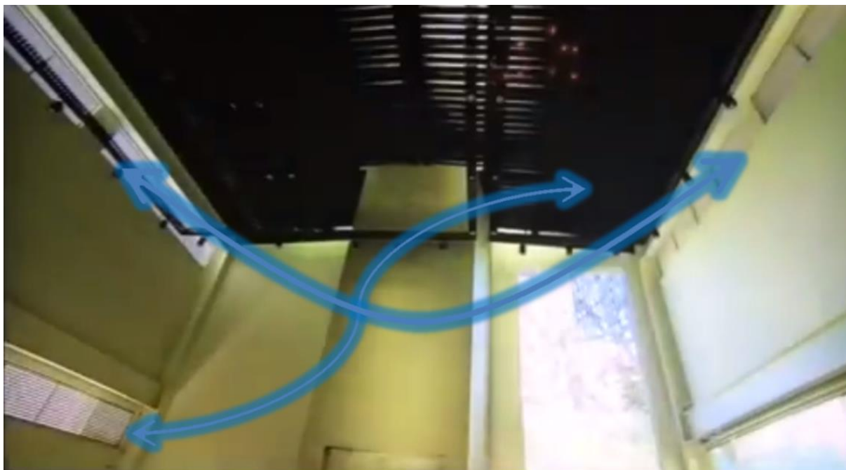
Figura 5.19: Ventilação cruzada do ambiente interno.
