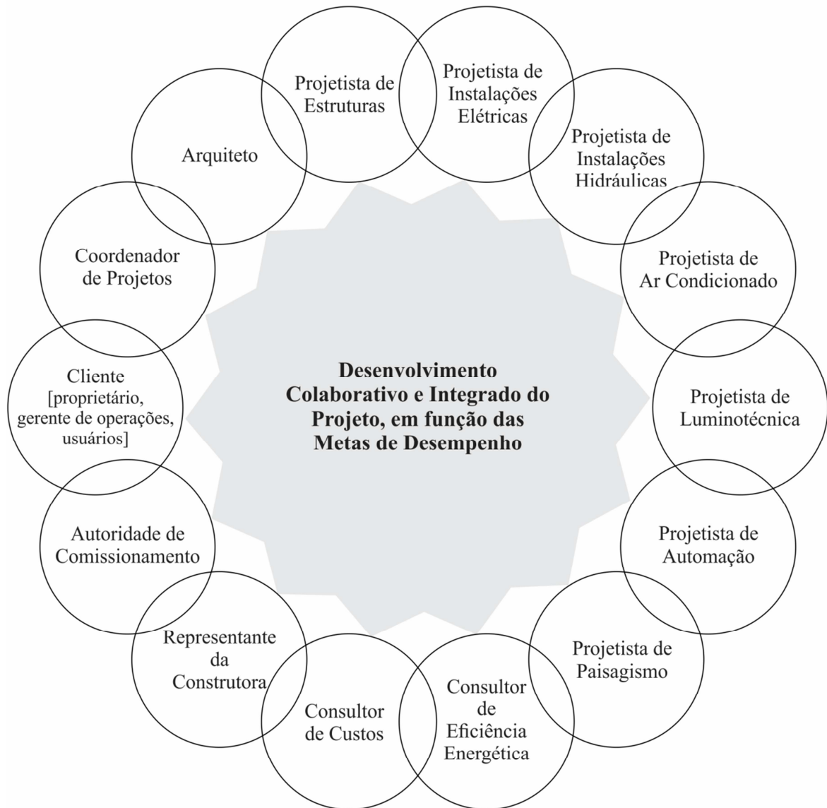
Figura 4.7 - Relação entre agentes em processos de projeto integrados Fonte: Adaptado de FIGUEIREDO (2009).
