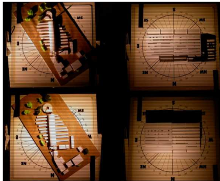
Figura A.5 - Avaliação do percurso do sol e do sombreamento com o auxílio do equipamento Heliodon
