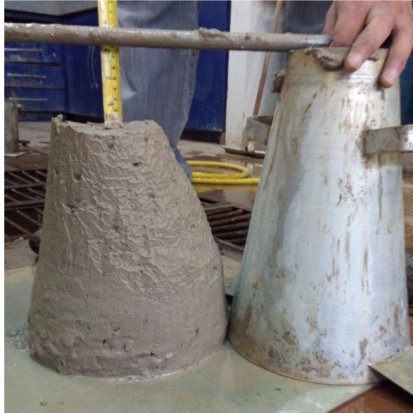
Figura 5.1- Análise da consistência do concreto pelo abatimento de tronco de cone.
