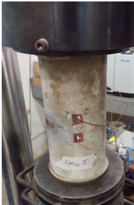
Figura 5.4 - Ensaio de módulo de elasticidade estático.
