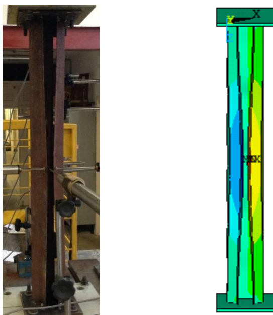
Figura A.41 - Comparação experimental e numérica do protótipo CM-F80-CP3 (flanges)
