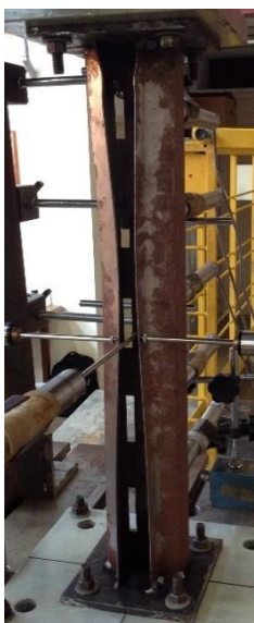
Figura A.12 - Comparação experimental e numérica do protótipo CF-F60-CP1 (flanges)
