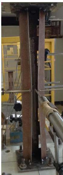
Figura A.16 - Comparação experimental e numérica do protótipo CC-F60-CP3 (flanges)
