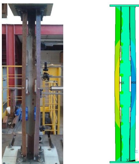
Figura 4.30 - Comparação experimental e numérica do protótipo CM-F80-CP1 (flanges)
