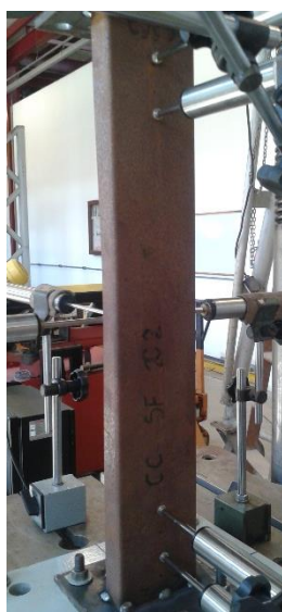
Figura 4.5 - Comparação experimental e numérica do protótipo CC-SFS-CP2 (alma)
