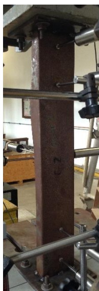
Figura A.6 - Comparação experimental e numérica do protótipo CC-SFS-CP3 (alma)
