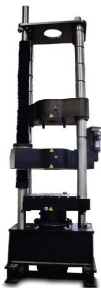
Figura 2.3 - Equipamento utilizado para aplicação de carga nos protótipos FONTE: Instron (2008)
