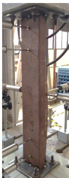
Figura A.2 - Comparação experimental e numérica do protótipo CC-SFS-CP1 (alma)
