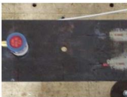
Figura 4.4 – Furo de 12 mm imposto a viga.
