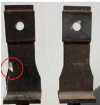
**Figura 4.13 – Posicionamento extensômetro no perfil "T" para medir a deformação específica do aço do perfil "T".**
