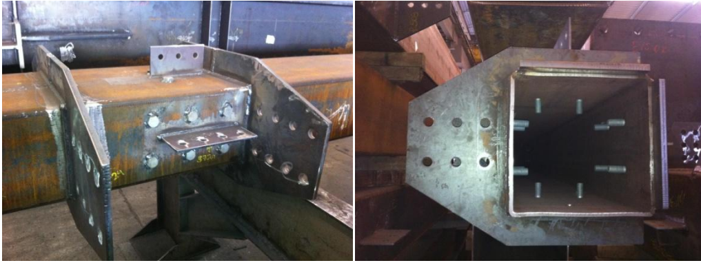
Figura 1.4 - Exemplo de aplicação de dispositivo de transferência de carga. (CODEME, 2012)
