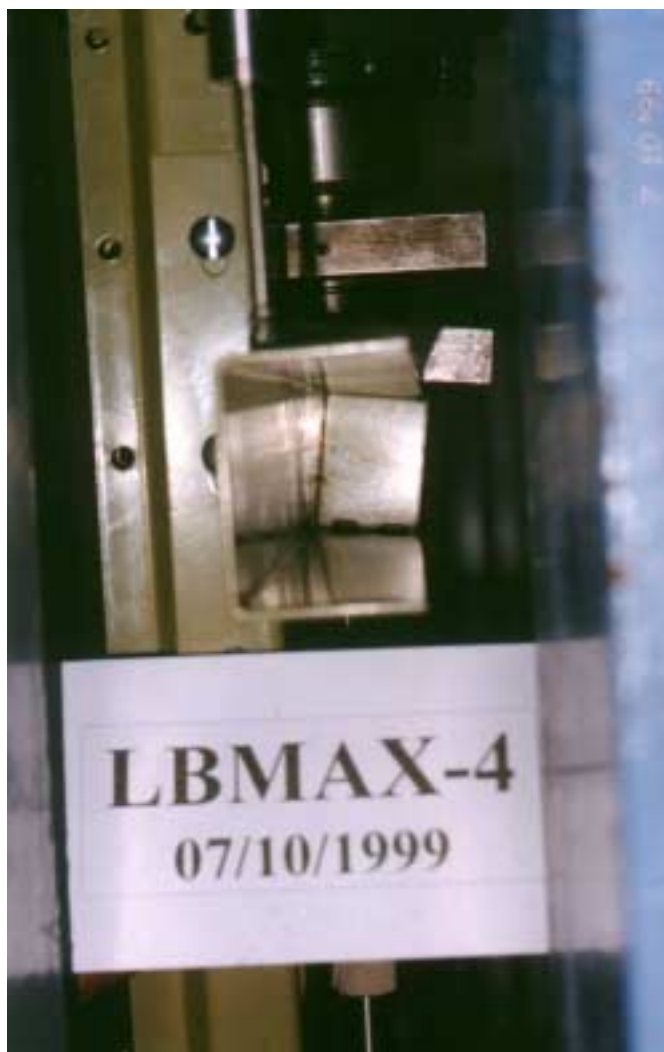
Foto 8.5. Vista da ligação do braço com a torção na extremidade de aplicação do carregamento.
