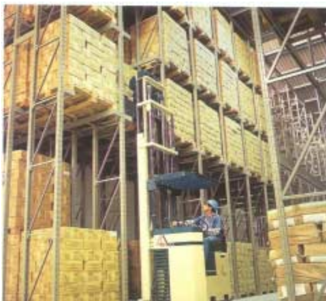
Foto 2.7. Sistema de armazenagem “drive-in”, (Águia (1999a)).
