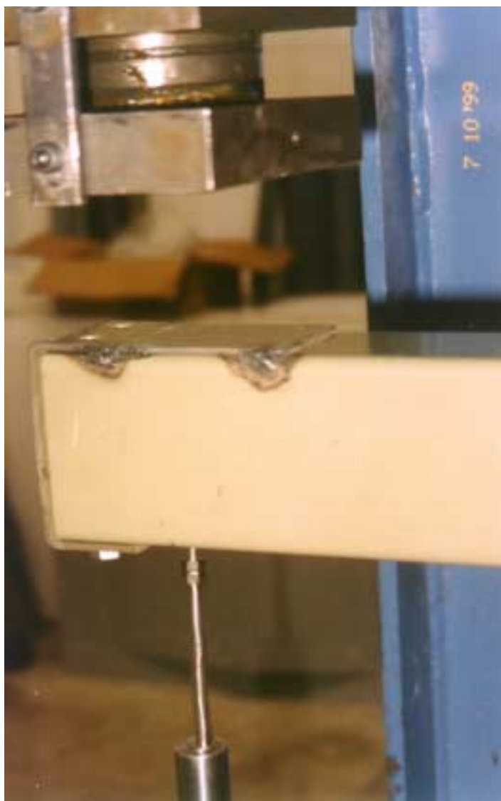
Foto 8.3. Detalhe da extremidade do braço com o enrijecimento da seção.
