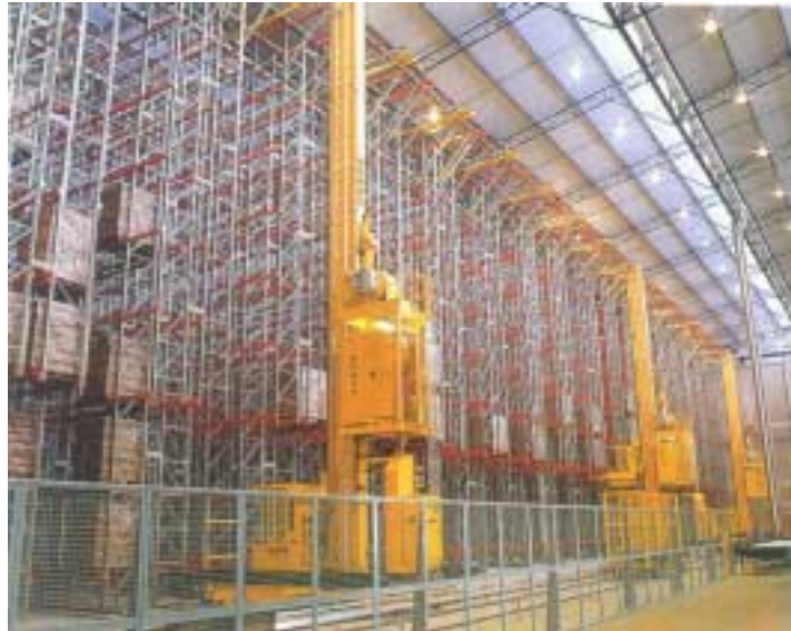
Foto 2.1. Sistema de armazenagem automatizado, (Águia (1999a)).
