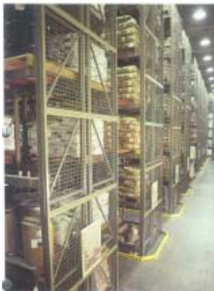
Foto 2.2. Sistemas de armazenagem de produtos de formato variado, (Águia (1999a)).
