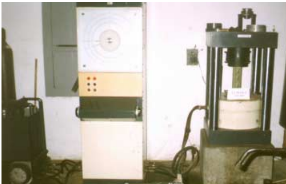
Foto 6.2. Esquema Geral de Montagem do ensaio da coluna curta
