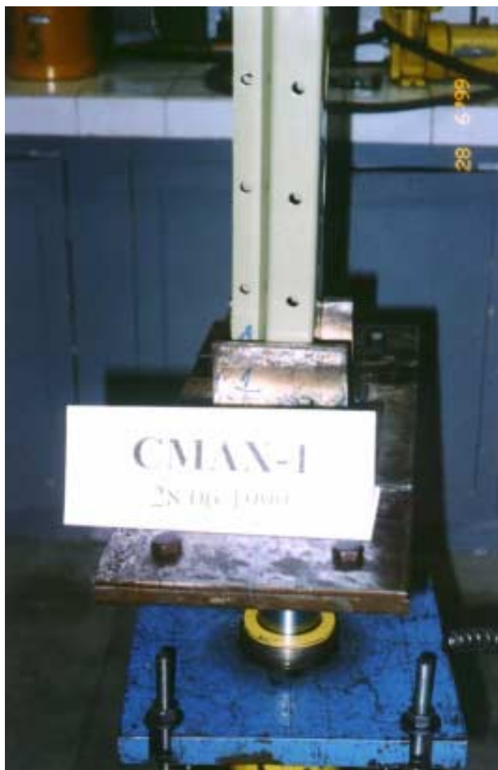
Foto 7.6. Flambagem por flexo-torção, na parte inferior da coluna.
