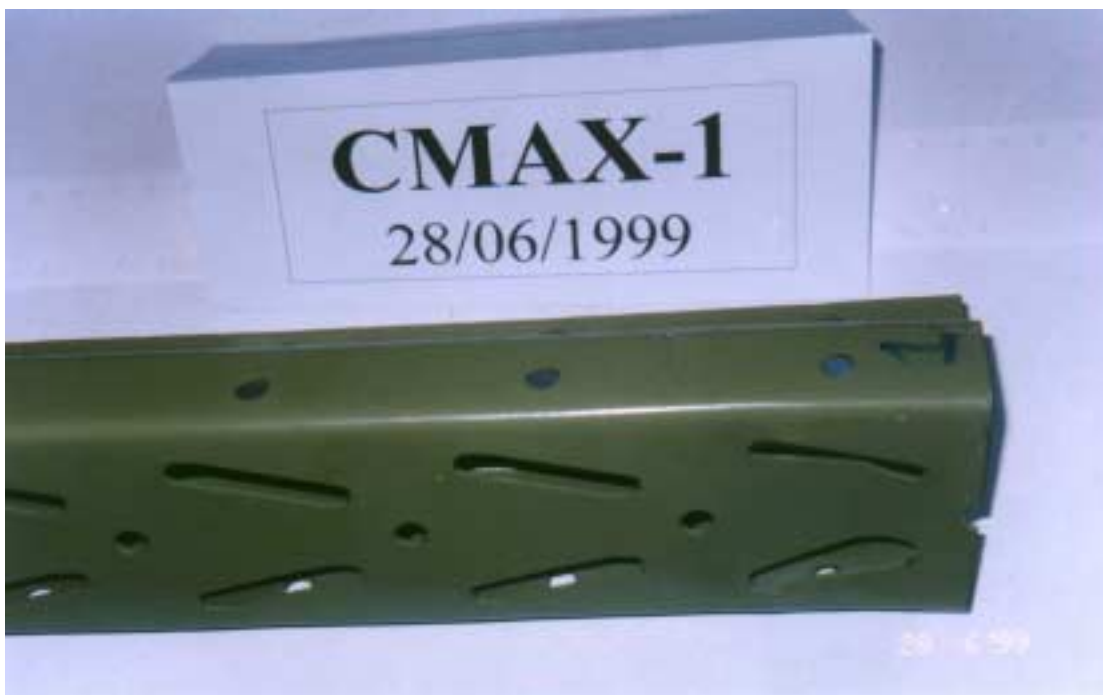
Foto 7.5. Plastificação da alma da seção transversal ao final do ensaio.
