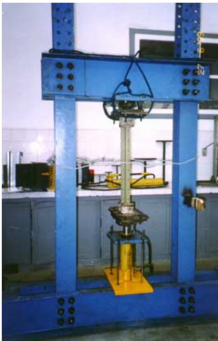
Foto 6.1. Esquema geral de montagem do ensaio da coluna longa.
