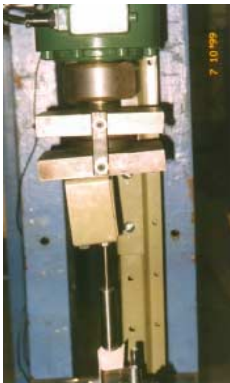
Foto 8.6. Vista frontal do braço do protótipo LBMAX-5, sendo visível a torção ao final do ensaio.
