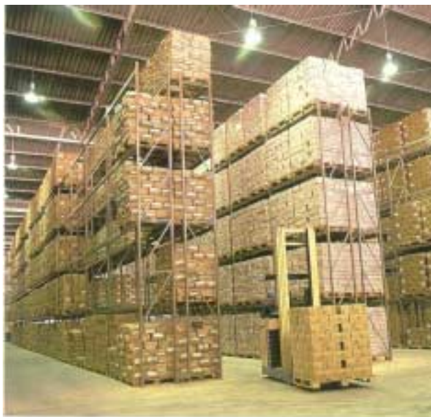
Foto 2.6. Sistema de armazenagem industrial “porta-pallets”, (Águia (1999a)).
