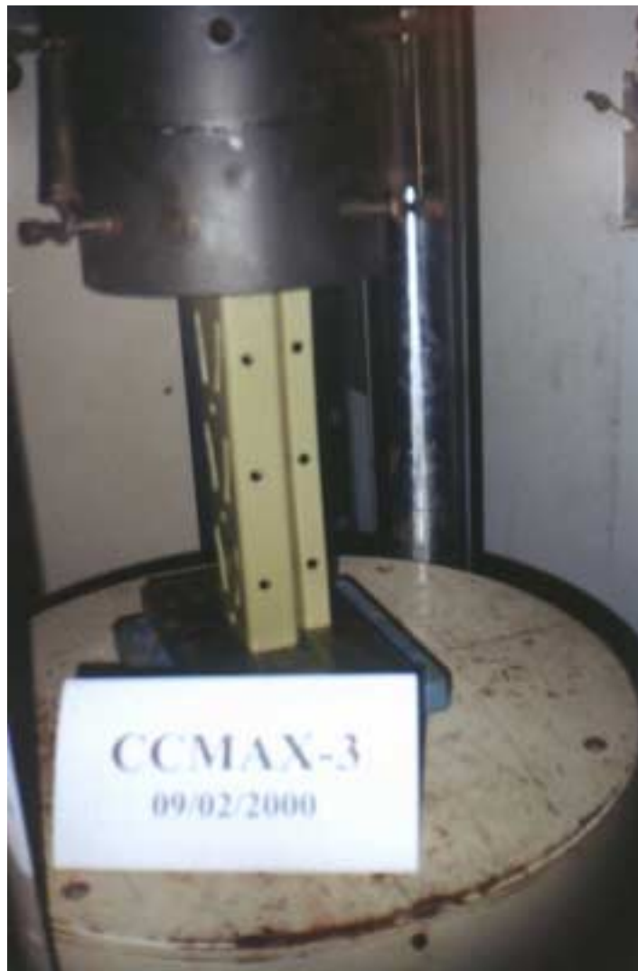
Foto 7.3. Vista do protótipo CCMAX-3, com deformação na extremidade inferior da alma da coluna.
