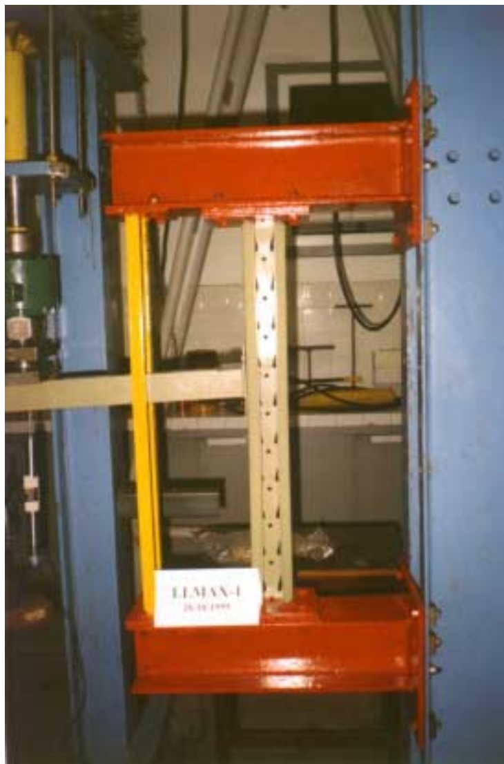
Foto 8.7.Deslocamentos obtidos ao final do ensaio do protótipo LLMAX-1.
