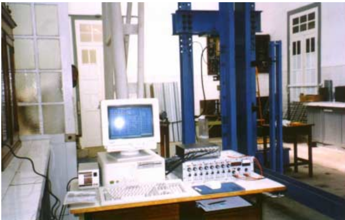
Foto 6.4. Detalhe dos equipamentos para aquisição de dados.
