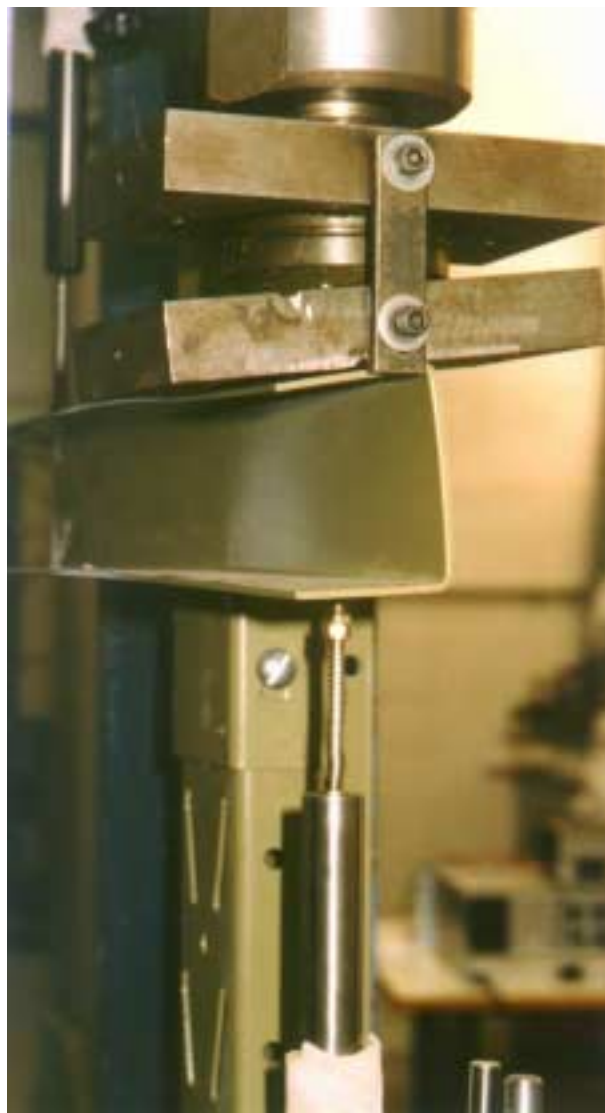
Foto 8.2. Vista frontal da extremidade do braço com o detalhe da torção e deformação da mesa superior da seção.
