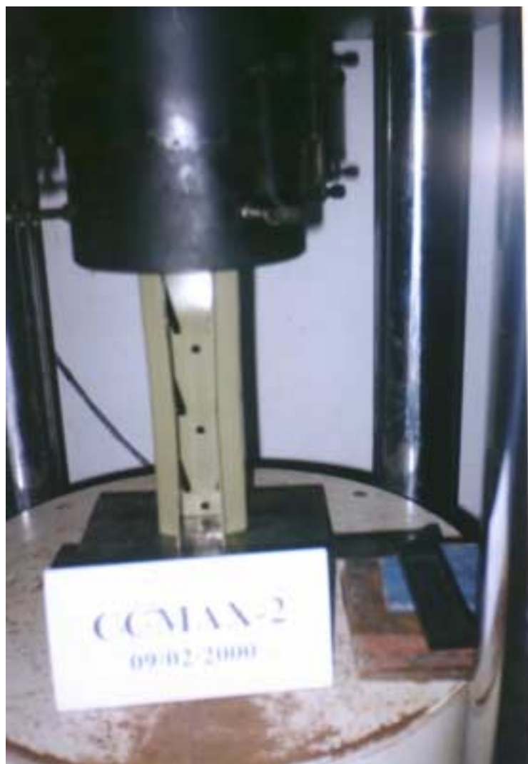
Foto 7.2. Vista das distorções nas extremidades da coluna pelo afastamento dos flanges de ligação e aproximação dos mesmos a meia altura da coluna (130 mm).
