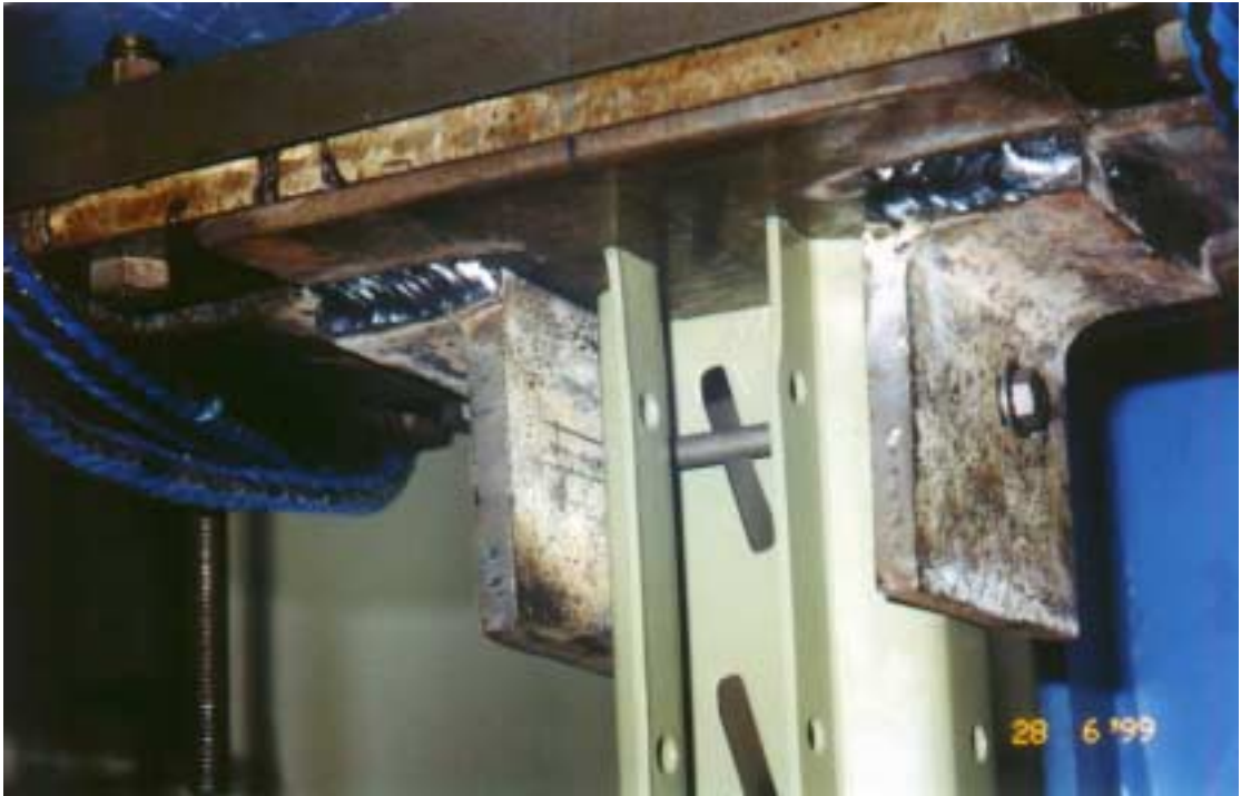
Foto 7.4. Variação da dimensão da garganta na extremidade superior do protótipo CMAX - 1.
