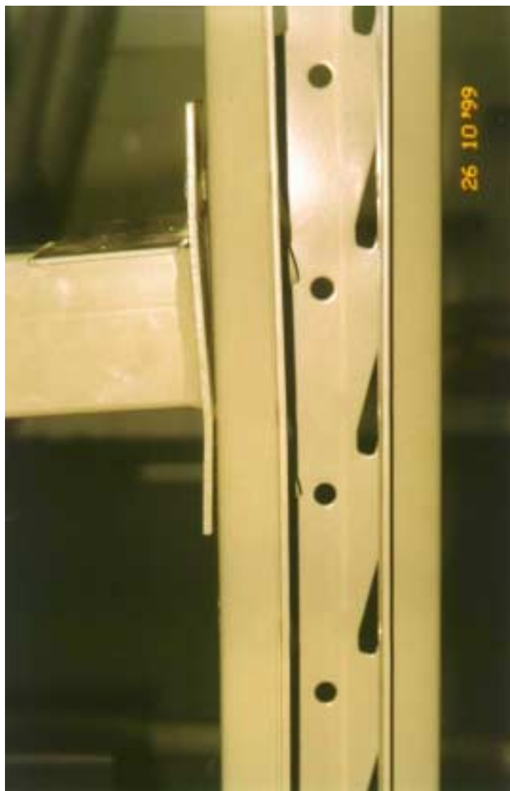
Foto 8.8. Deformação do suporte da ligação do lado oposto aos dentes.
