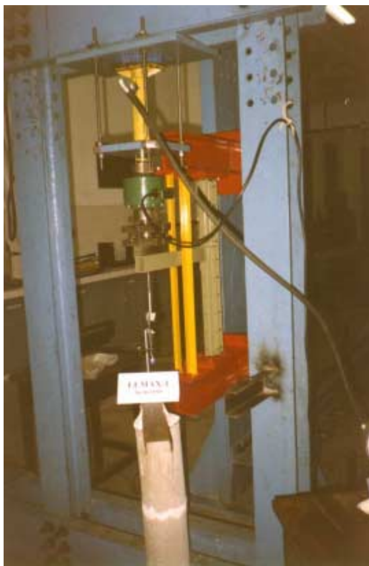
Foto 6.5. Esquema geral de montagem do ensaio da ligação da longarina.
