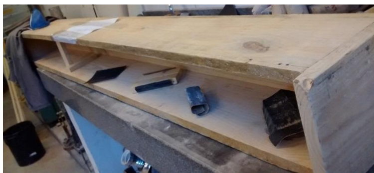
Figura 19. Montagem das paredes e fundo do forno elétrico.
