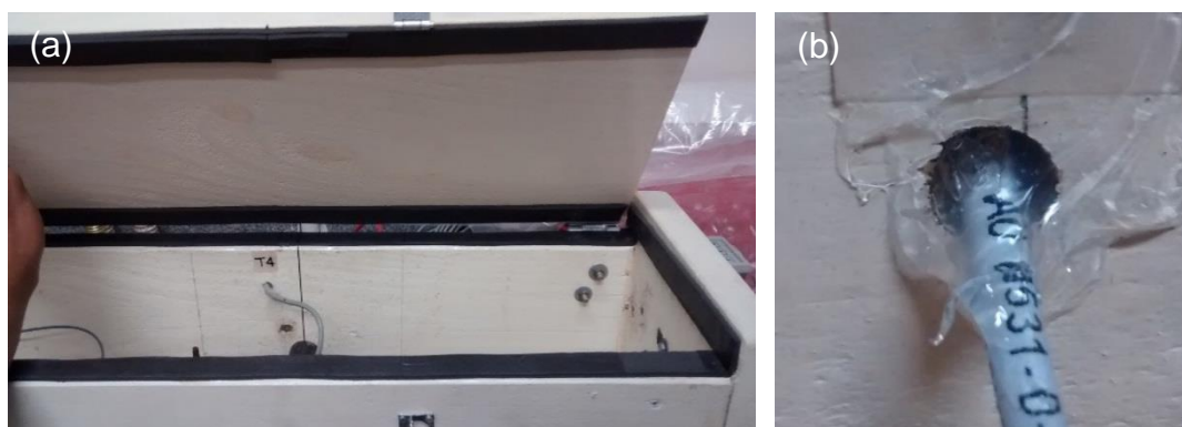
Figura 22. (a) Vedação da parte superior do forno com fita de espuma de polietileno e (b) vedação com silicone nos espaços dos furos para os cabos.
