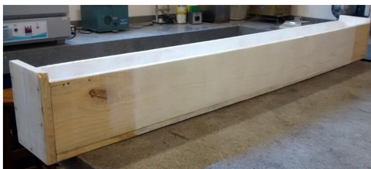
Figura 20. Acabamento interior e exterior das paredes e tampas do forno.
