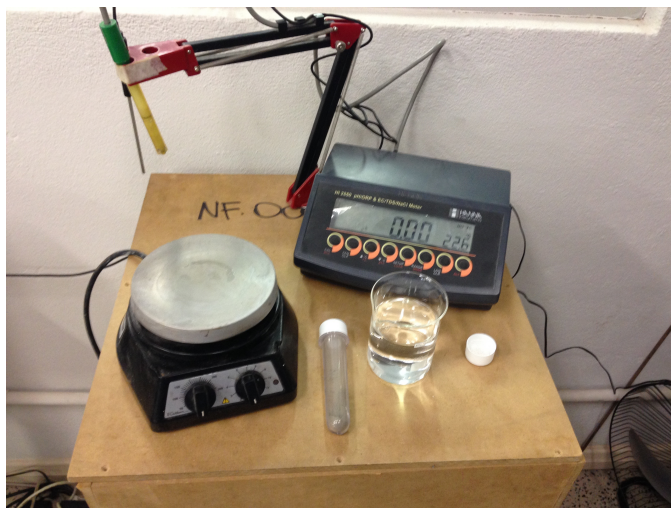
Figura 3.9: Equipamentos Adotados no Ensaio de Condutividade Elétrica (Fonte: Autor).
