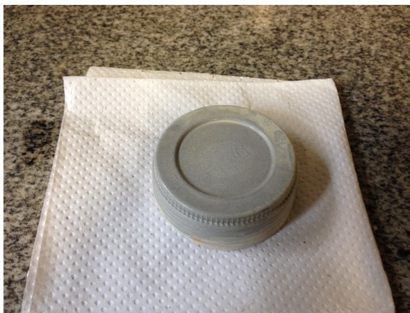
Figura 3.11: Pasta de Cimento Portland após a Cura e Desmoldagem (Fonte: Autor).
