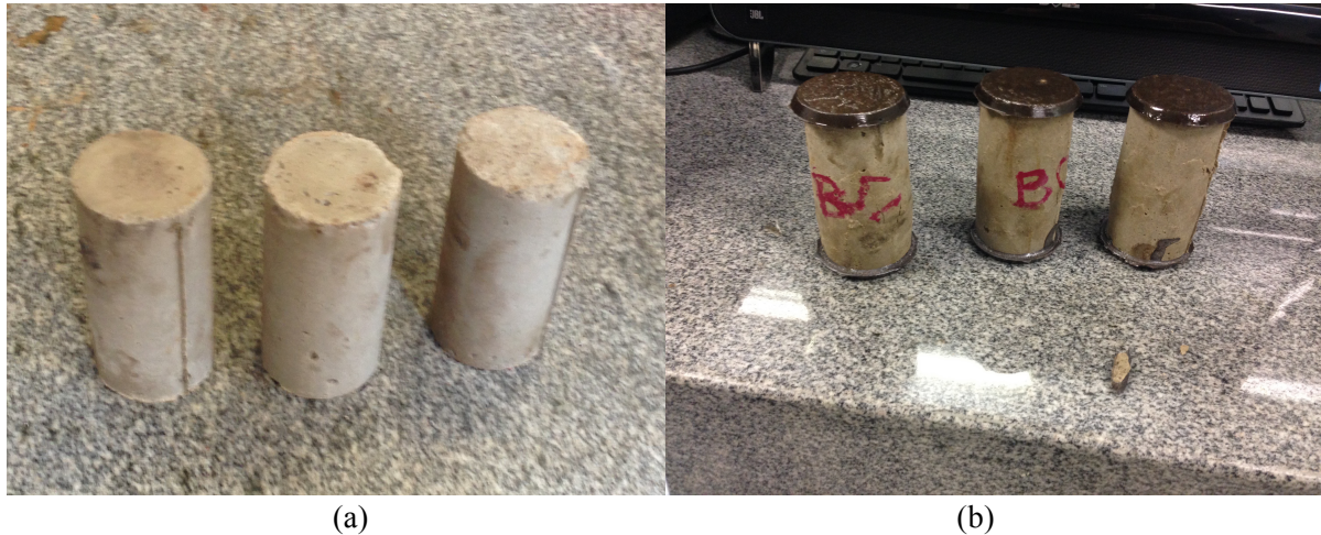
Figura 3.8: Corpos de Prova (a) Sem Capeamento (b) Com Capeamento de Enxofre (Fonte: Autor).
