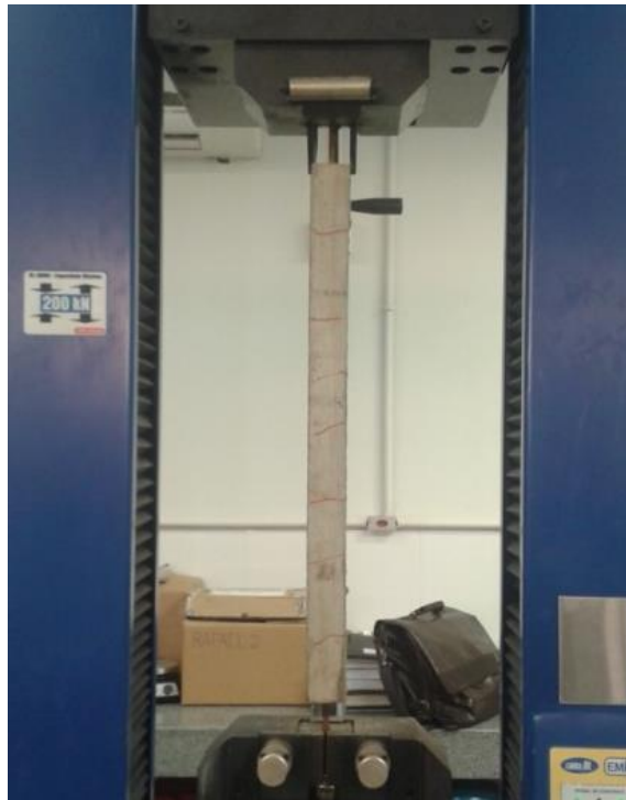
Figura 3.17: Execução do ensaio de conformação superficial
