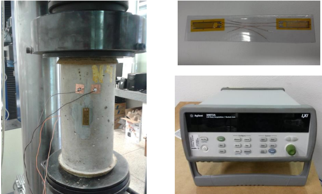
Figura 3.11: Detalhes do ensaio de módulo de elasticidade
