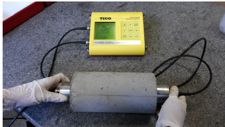
Figura 3.12: Execução do ensaio de módulo de elasticidade dinâmico
