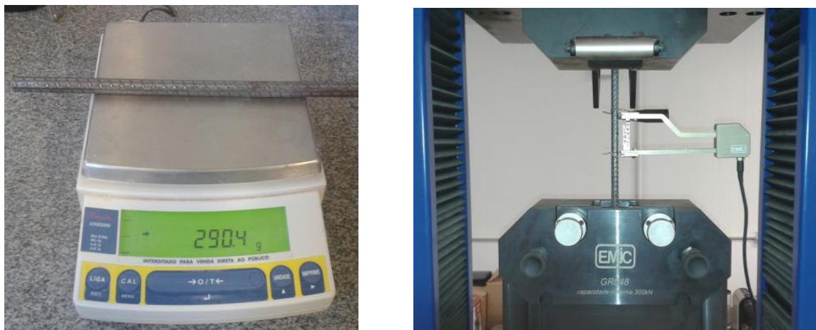
Figura 3.8: Caracterização das barras tipo CA utilizadas
