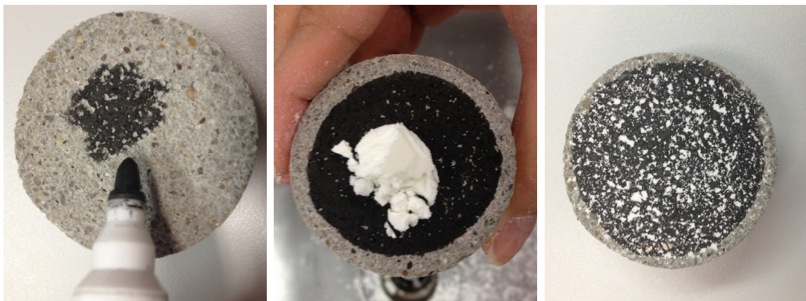
Figura 22 – Processo de pintura para aumento do contraste entre os poros e a matriz
