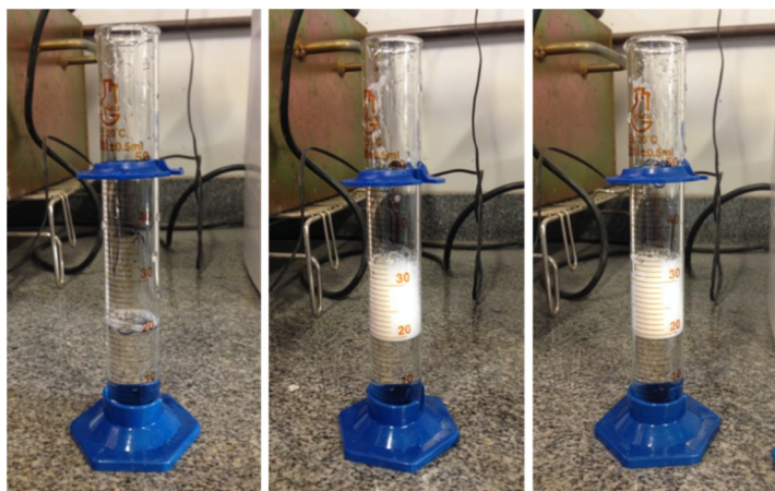
Figura 18 – Ensaio da estabilidade da espuma da solução A4: ao inserir a solução, volume inicial após agitação e volume final após repouso
