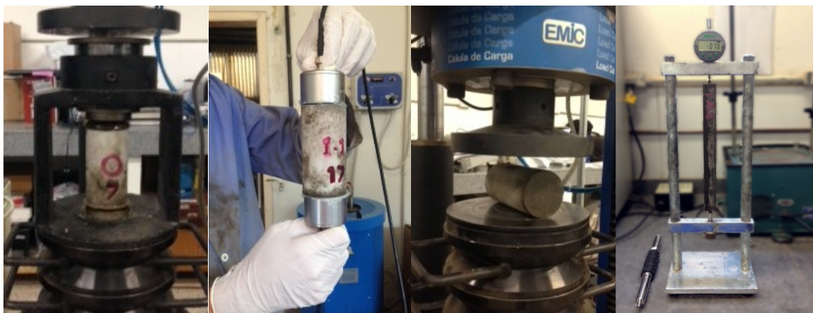
Figura 20 – Ensaios de Compressão, Módulo de Elasticidade Dinâmico, Tração por Compressão diametral e Retração, respectivamente.
