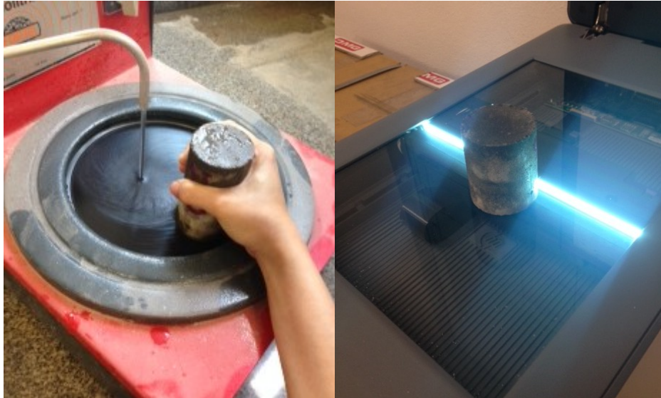
Figura 21 – Corpos-de-Prova para análise morfológica, sendo lixados e escaneados
