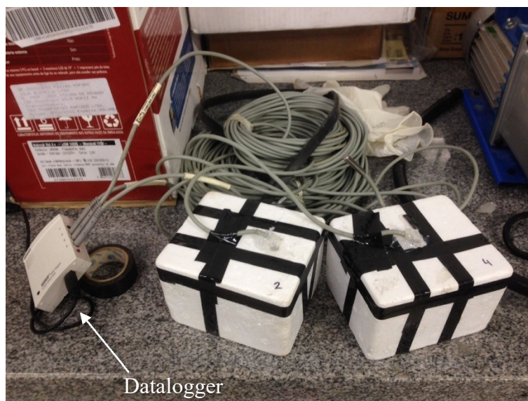
Figura 17 – Ensaio de curva de calor de hidratação em andamento
