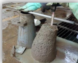
Figura 4.20: Slump concreto com ANR-C30
