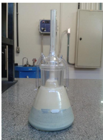
Figura 3.12. Determinação da massa específica
