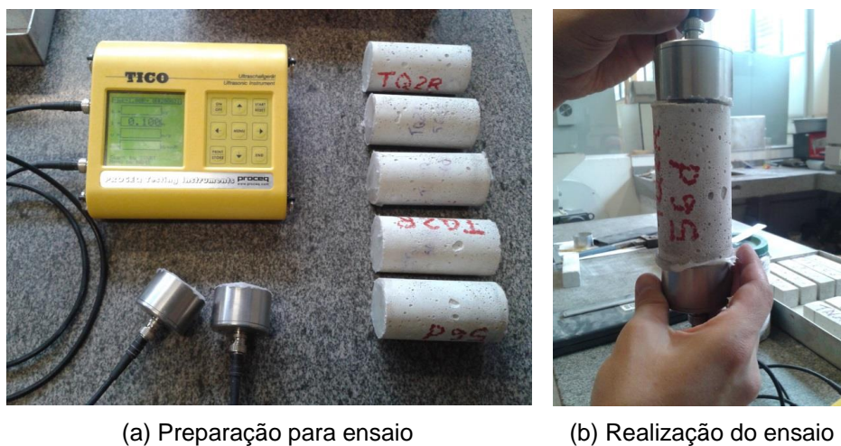
Figura 3.25. Realização do ensaio de módulo de elasticidade dinâmico
