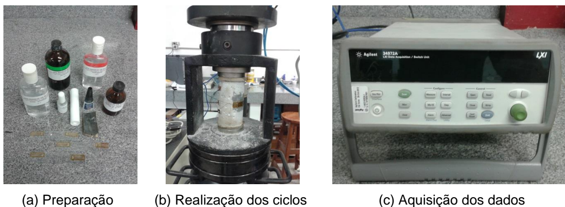
Figura 3.27. Determinação do módulo de elasticidade estático
