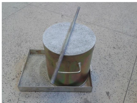
Figura 3.13. Determinação da massa unitária
