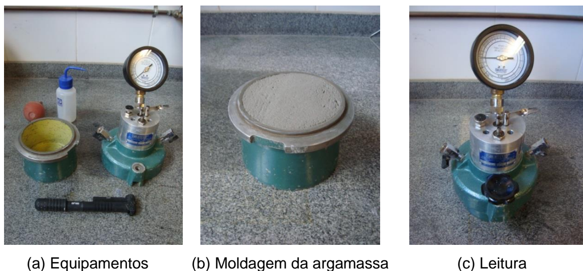
Figura 3.20. Procedimentos para obtenção do teor de ar incorporado
