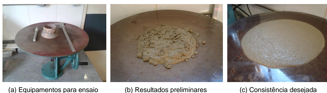
Figura 3.17. Determinação do índice de consistência das argamassas
