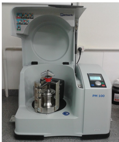
Figura 3.29. Moinho de alta eficiência para preparação de amostras
