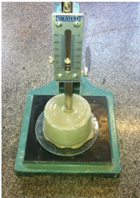
Figura 8: Aparelho de Vicat modificado.
