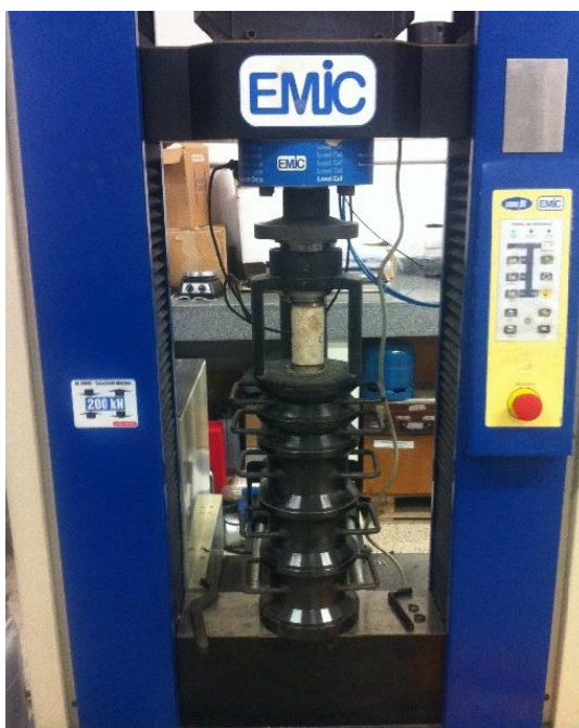
Figura 12: Determinação da resistência à compressão, aos 28 dias.
