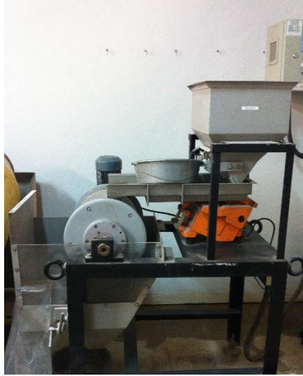
Figura 5: Rolo magnético INBRAS utilizado.
