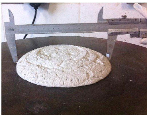
Figura 9: Medida de consistência.
