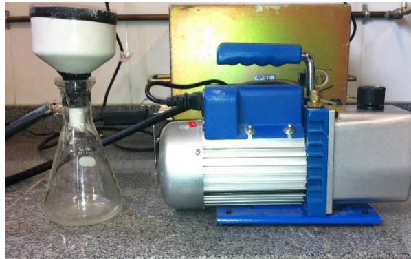
Figura 10: Determinação da retenção de água das argamassas pelo funil de Buchner.
