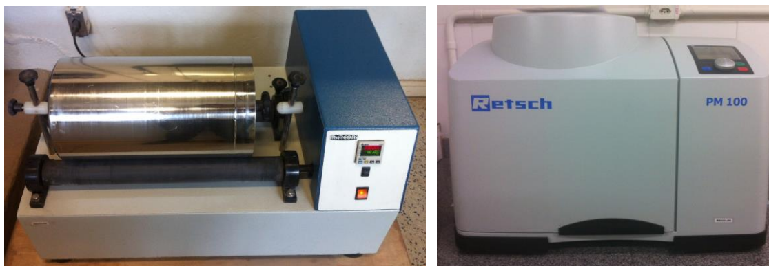
Figura 6: Moinhos (a) de baixa eficiência MARCONI MA500 e (b) de alta eficiência RETSCH PM100.
