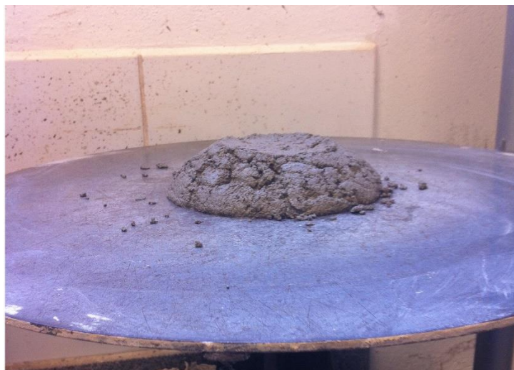
Figura 11: Medida do índice de consistência.
