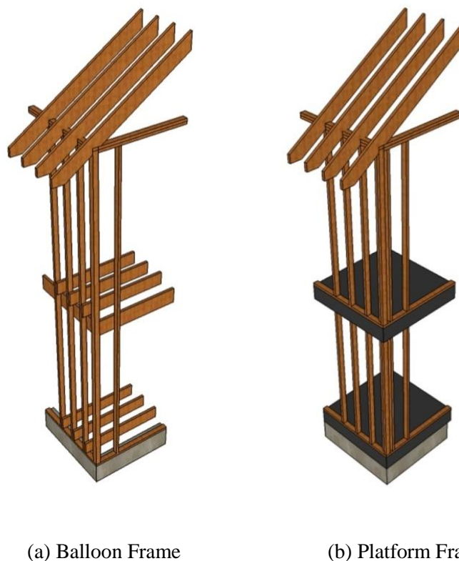
Figura 2.3 - Esquemas de Balloon Frame e Platform Frame
