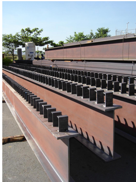
Figura 2.6 – Conector tipo perfil U laminado (SOUZA, 2014)
