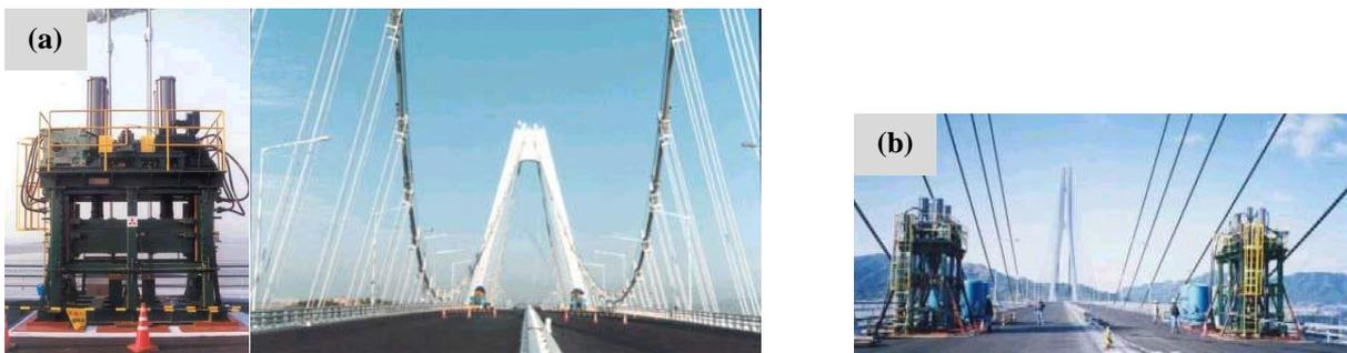
**Figura 3:** (a) Ensaio dinâmico de vibração forçada na ponte pênsil de Yeongjong (a), Coreia do Sul, (<http://www.yeongjongbridge.com>) e na ponte estaiada de Tataru (b), Japão (<http://www.hsba.go.jp>).
