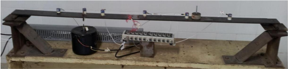
**Figura 46:** Viga de aço instrumentada.
