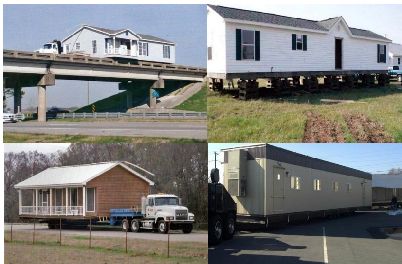
Figura 3.10: Casas modulares transportáveis. EUA Fonte: DE VILLIER, 2014.
