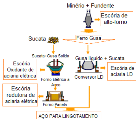
Figura 3– Desenho esquemático da produção do aço. Fonte: Masueroet al., 2004.
