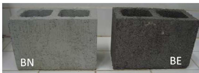
Figura 28– Bloco de concreto para alvenaria estrutural e bloco de escoria de aciaria.
