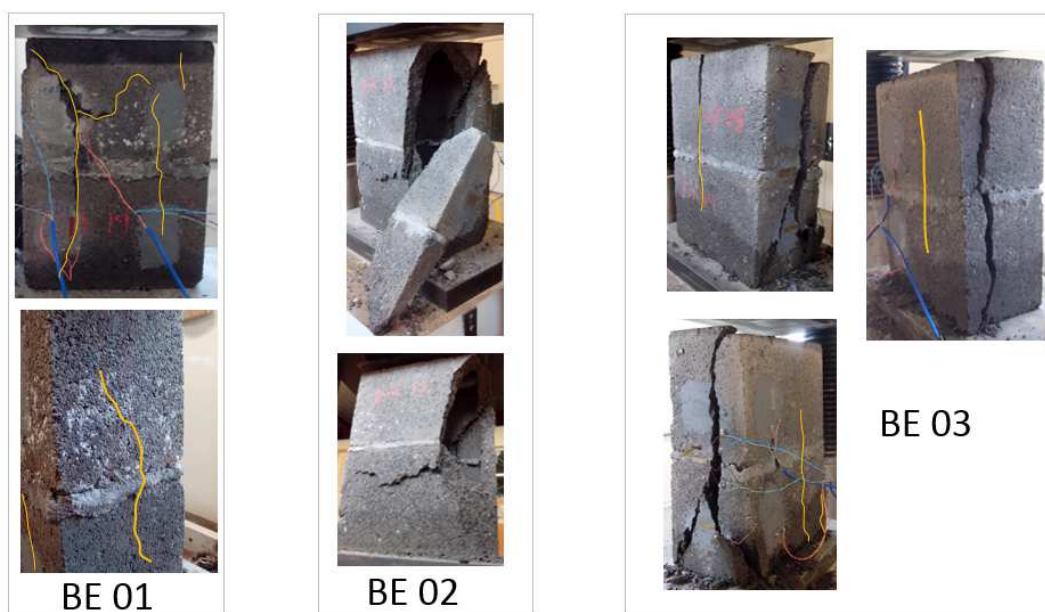
Figura 63– Modo de ruptura dos prismas de escória.
