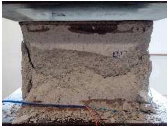
Figura 42 - Modo de ruptura para deformação transversal
