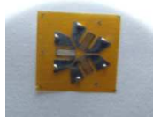
Figura 14–Imagem da roseta utilizada neste trabalho, fabricante Excel Sensores.
