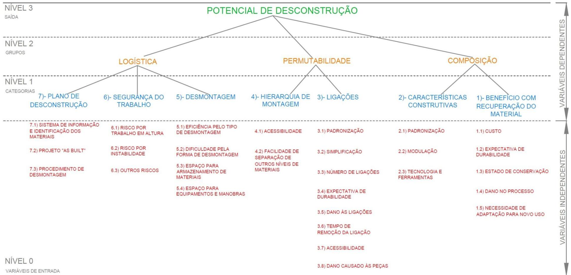
Figura 8.1: Estrutura inicial do sistema de análise baseado em lógica fuzzy.
