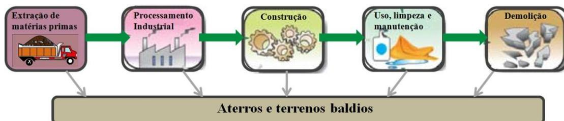
Figura 1.1: Fluxo aberto de produção dos materiais de construção, com a maior parte dos resíduos sendo acumulados em aterros.
