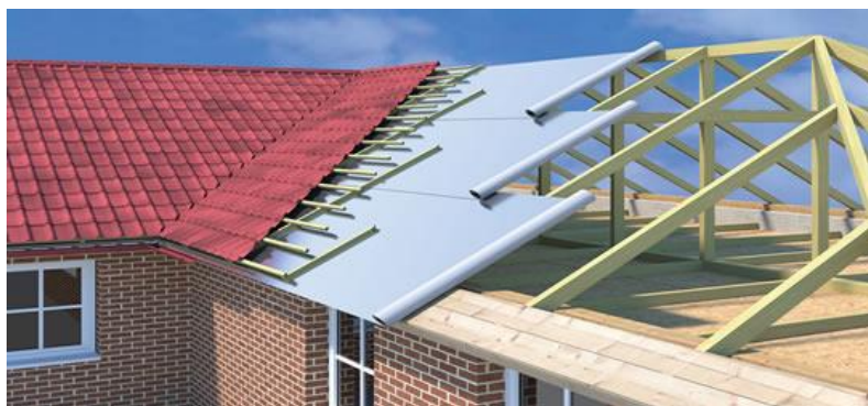
FIGURA 4.20 – Telhado com telha de fibra vegetal com manta térmica.
