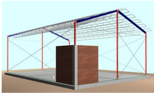
FIGURA 2.9 – Estrutura metálica montada e contraventada.
