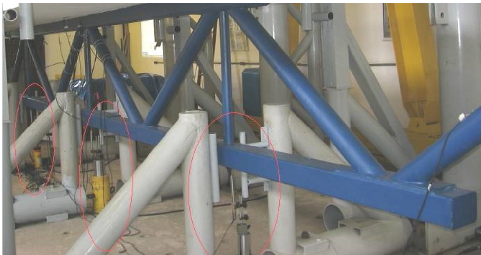
a) Transdutor de deslocamento para medir o deslocamento da laje em relação ao banzo em nó superior.
