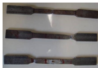
b) Aspecto após a ruptura
