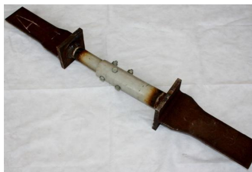
(d) Protótipo soldado no perfil "T".
