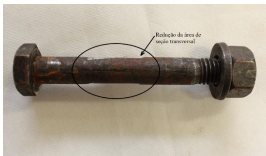
(a) Parafuso com redução na seção transversal.
