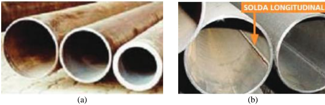
Figura 1.2 - Tubos estruturais: (a) sem costura; (b) com costura. (Araújo, 2011)
