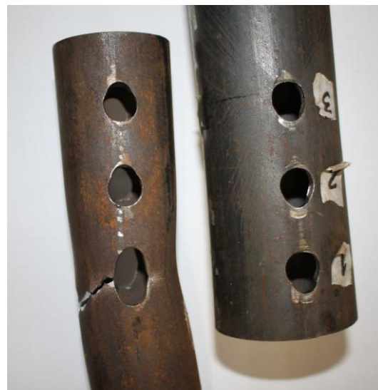
(b) ruptura no tubo interno.
