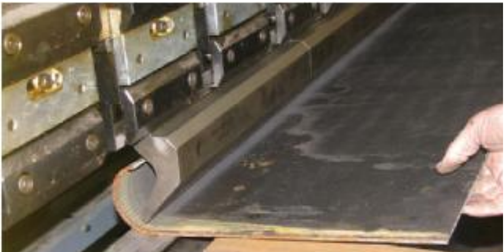
Fig. 1.1 – Processos de fabricação dos perfis formados a frio. (a) Perfilagem (Vrany, 2010). (b) Dobramento (Sabbagh et al. , 2011)
