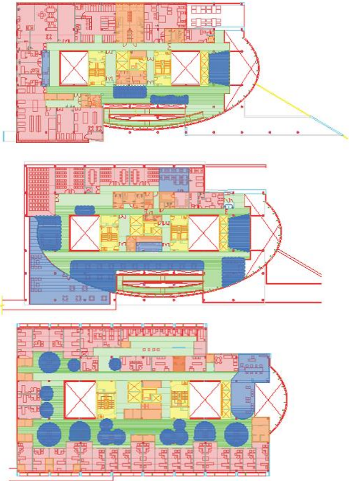
FIGURA 7. 19 – Manchas de iluminação nos pavimentos 3,4 e5. Fonte: CASTANHEIRA 2012
