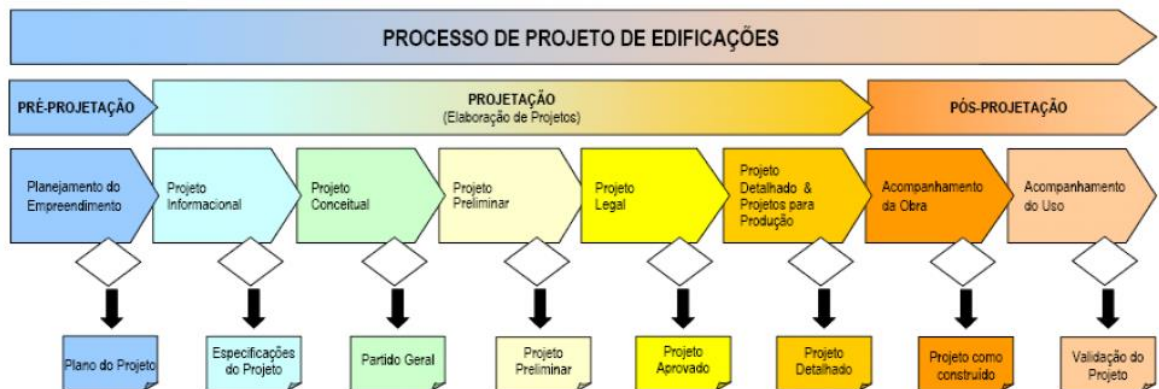
Figura 7.4 - Fases do processo de projeto de edificações.
