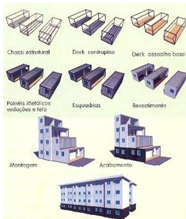
(c) elementos que compõem o sistema construtivo
