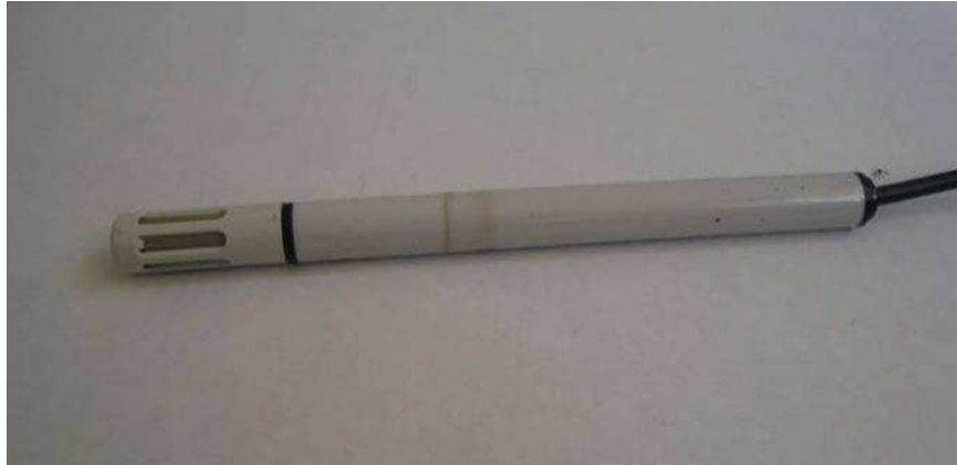
Figura 3.20 -Sensor usado para medir Temperatura Ar.
