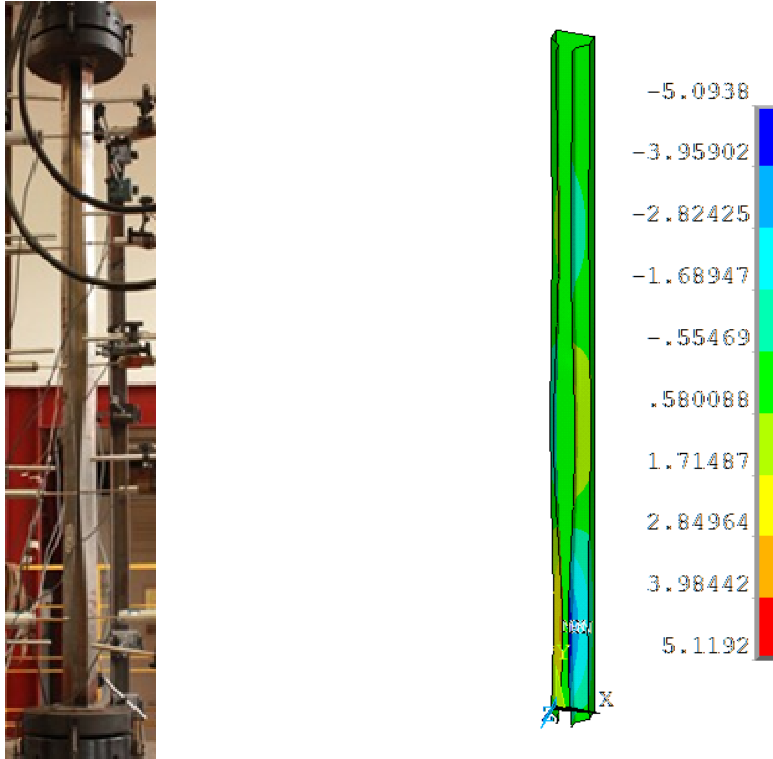
Fig. C.40. Comparação dos deslocamentos experimentais e numéricos.
