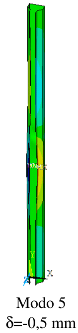
Fig. C.36. Modos utilizados para introduzir a imperfeição inicial e suas amplitudes.
