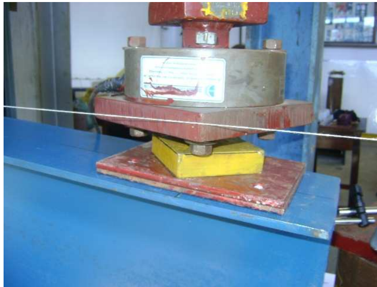
Figura 4.58– Deformação final da viga do protótipo MIE6b
