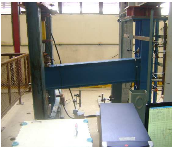
Figura 4.23 - Deslocamento finais das vigas dos protótipos AIE5a (i) e AIE5b (ii)
