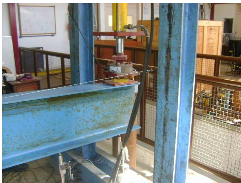
Figura 4.84 – Deformação final da viga do protótipo MIE2a
