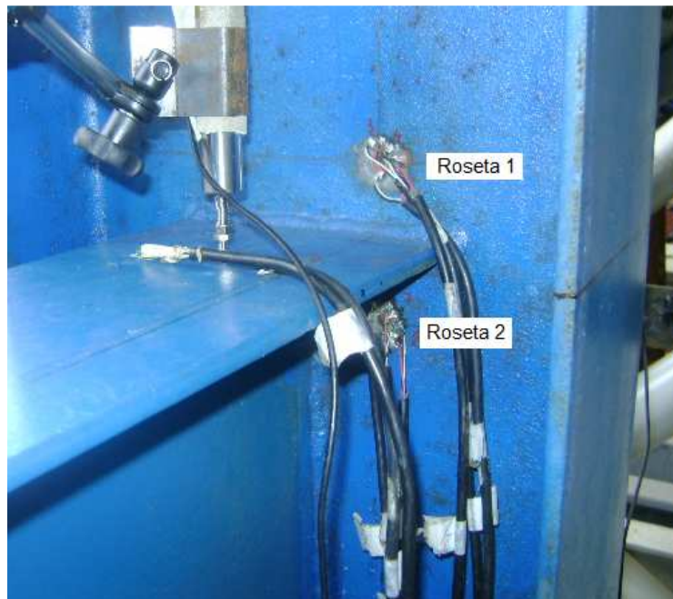
Figura 4.46 – Rosetas 1 e 2 instaladas na alma do pilar, acima da mesa tracionada da viga
