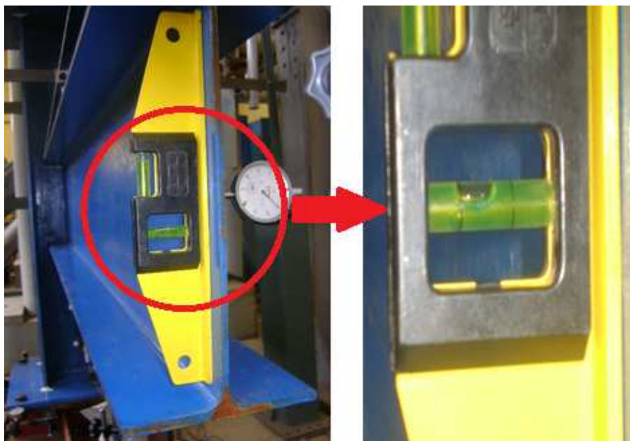
Figura 4.110 – Rotação da seção transversal da extremidade da viga (Protótipo BIE2)
