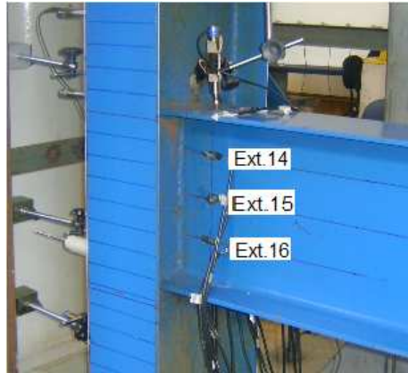
Figura 4.43 – Extensômetros posicionados na alma da viga dos protótipos ensaiados
