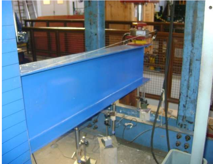
Figura 4.57 – Deformação final da viga do protótipo MIE6a
