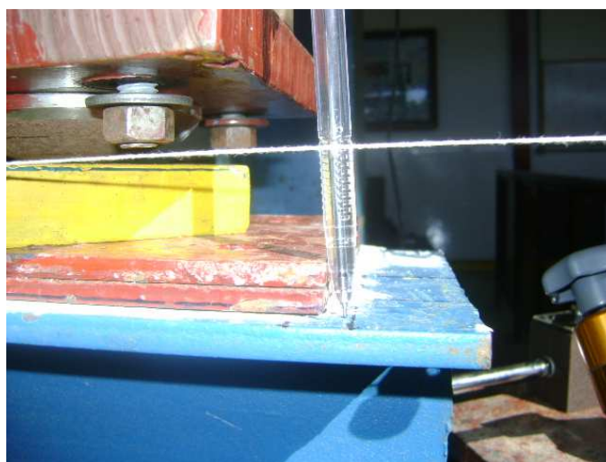
Figura 4.85 – Detalhe do deslocamento vertical final de extremidade da viga do protótipo MIE2b
