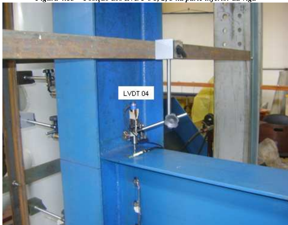
Figura 4.14 - Posição do LVDT 4, na mesa superior da viga
