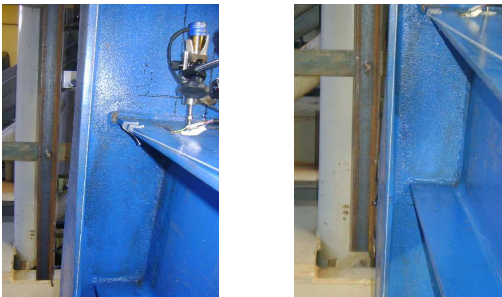
Figura 4.55 – Deformação das mesas do protótipo MIE6a
