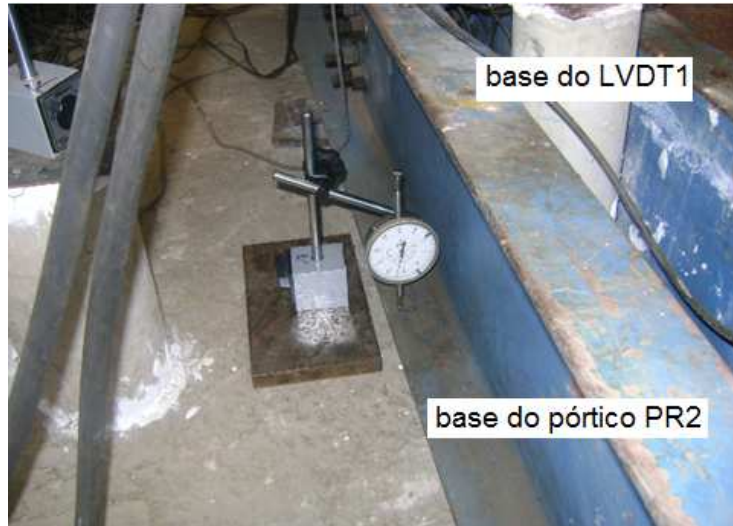
Figura 4.109 – Defletômetro posicionado na base do Pórtico PR2 (Protótipo BIE2)
