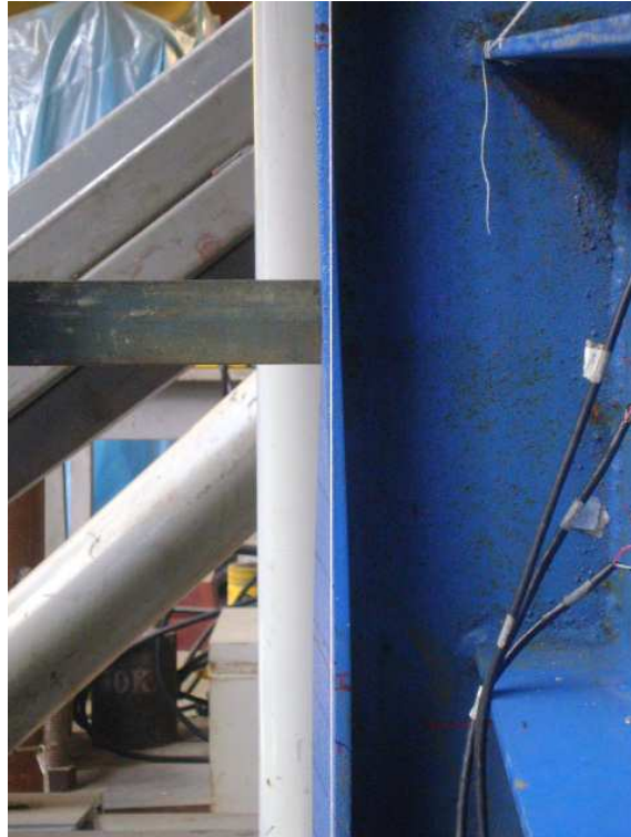
Figura 4.22 – Deformação das mesas do pilar do protótipo AIE5b
