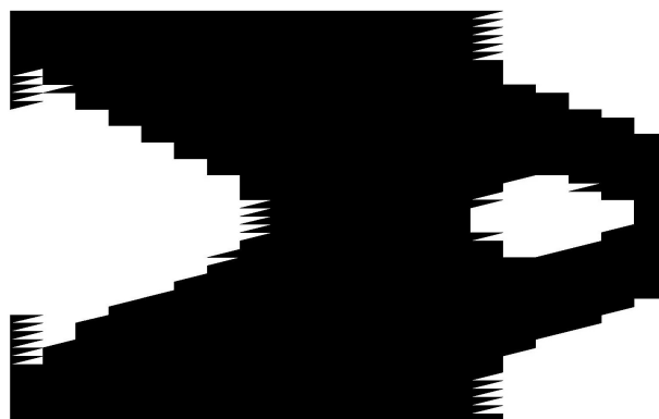
Figura 5.14: Topologia final ótima, resultante na iteração 3, usando o elemento QST
