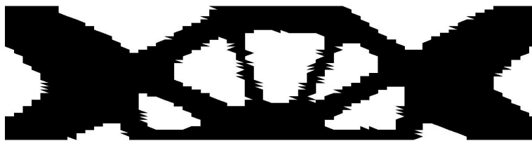
Figura 6.14: Topologia resultante, na iteração 65, usando o FFT (Análise Linear)
