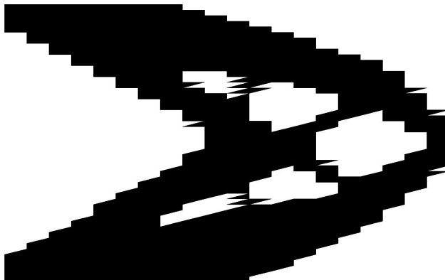
Figura 5.17: Topologia final ótima, resultante na iteração 38, usando o elemento QST
