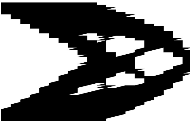
Figura 5.16: Topologia final ótima, resultante na iteração 15, usando o elemento QST
