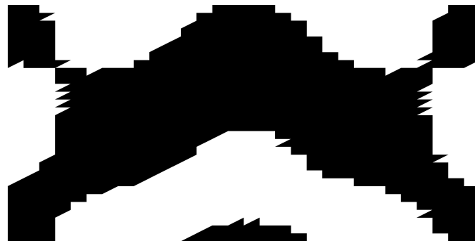
Figura 5.34: Topologia final ótima, resultante na iteração 3, usando o elemento QST
